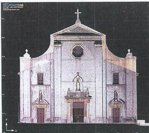
Relevé de la façade au moyen d'un scanner en 3 dimensions. Konan le Joncour, Géomètre-expert - 83 510 LORGUES
